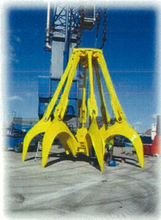
Pulpo utilizado para mejorar el sistema de carga de buques de chatarra
